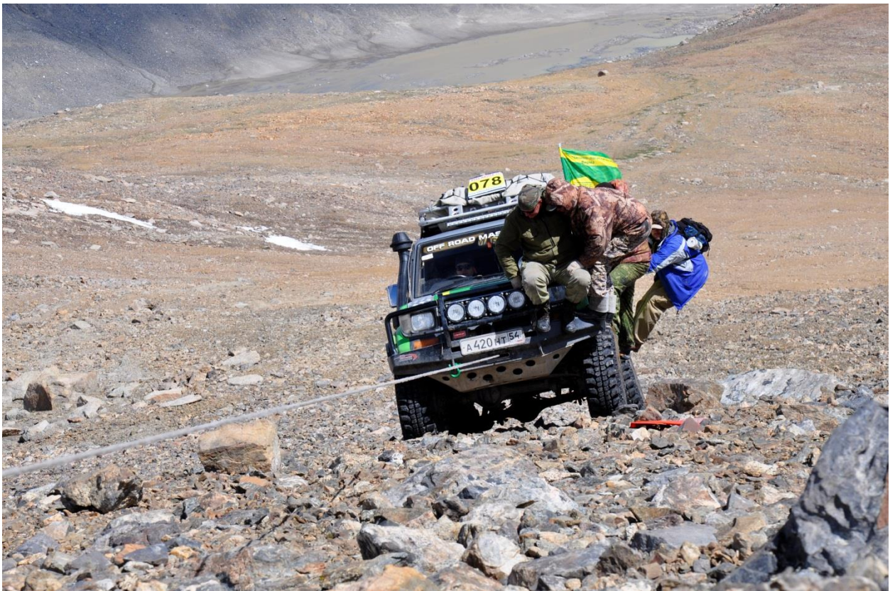
26. Подъем по куруму. Отвешивание автомобиля при крене. Помощь лебедкой на крутых участках.
