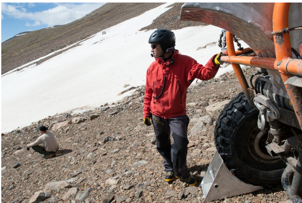
Фото 2. Противооткатное устройство на БАГГИ.
